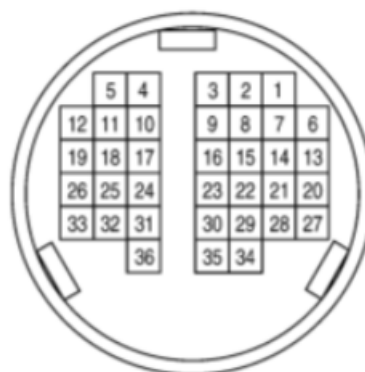
Rys. Podłączenie gniazda master 2013-2023 oraz Battery Monitor.
