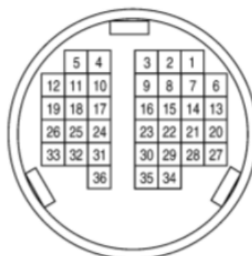
Rys. Podłączenie gniazda master 2013-2023 oraz Battery Monitor.
