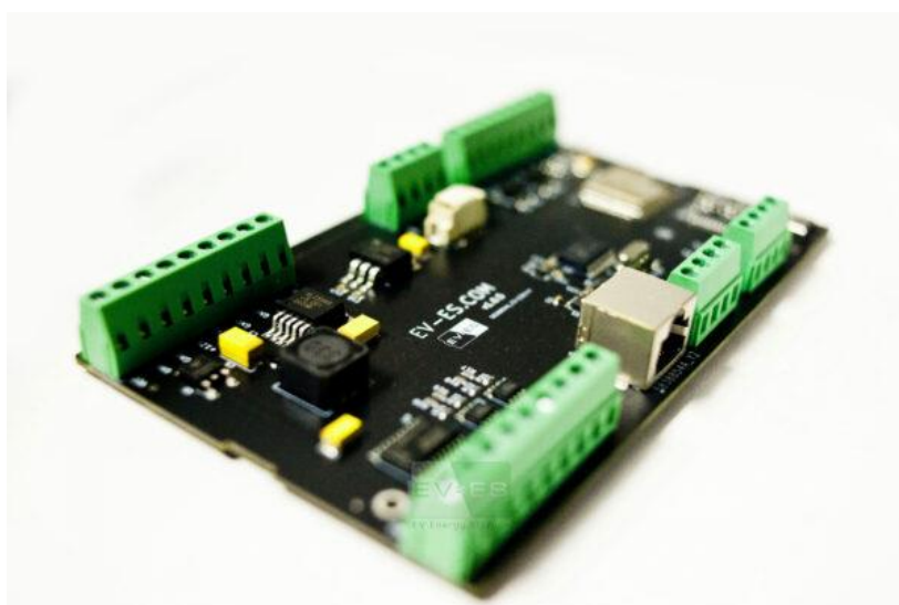
Rys. 2.1. Płytki PCB EV-ES Battery Monitor
